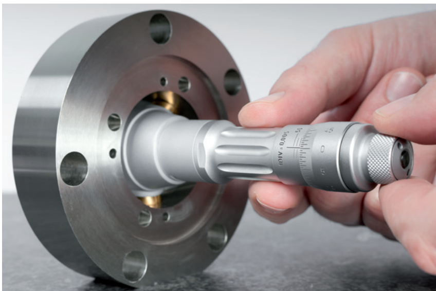
Misura di un foro con un micrometro per interni TESA IMICRO
